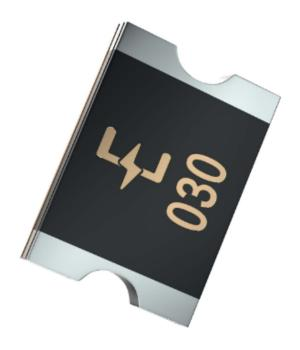
贴片保险丝的电流分析,贴片保险丝是在小型保险丝行业中技术含量相对比较高的新品种,它可以分为一次性贴片保险丝和贴片自恢复保险丝。小编带领大家-起分析下贴片保险丝的电流。正常电流:流经在正常电流使用的电路芯片的导火索。通常我们要减少的预先设定的金额的差额,然后按选择以下原则:即正常的电流必须小于额定电流和产品的降额因子。怎么检测贴片保险丝?找一细缝衣针,用细铜丝缠绕绑于万用表表笔上,再加锡,就很容易测量较小的贴片元件。直接用万用表电阻档,电阻为0就是通的。南京环保贴片保险丝型号一次性贴片保险丝分快断型系列跟慢断型系列。
