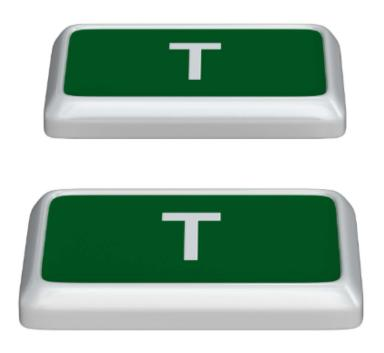
贴片保险丝的额定电流,它是一种规格的标称,而流过保险丝的电流大到何种地步、何时熔断这在保险丝产品标准中对它有详细的规定,又因标准的不同而规定亦有所不同。保险丝有一个"熔断系数"其值大于"1"(一般在1.1至1.5之间),它是"常规不熔断电流"与"额定电流"的比值。由此可以看出,即使流过保险丝的电流大于它的额定电流而未超过常规不熔断电流,保险丝也不应该发生熔断现象。贴片保险丝额定电压与电流的选择,电压比较简单,大于工作设定的高电压即可。电流的话,一般选择标准是大于工作电流的1.5倍左右,大概范围就这样大小点也无妨,因为保险丝是短路过载保护这种情况下起作用。另外如果是自恢复保险丝的话有个因素得考虑,就是工作的环境温度。
