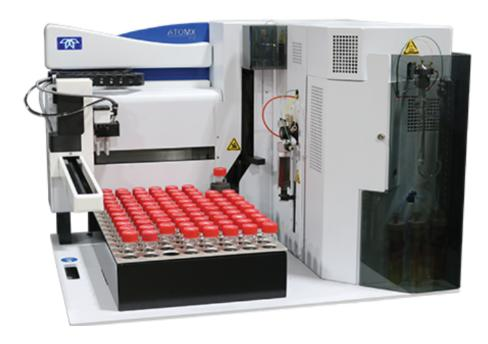
固液一体吹扫捕集仪的VOC解决方案固液一体国标吹扫捕集仪集成了自动进样器和吹扫捕集装置,可用于固体或液体中的VOC前处理。全自动吹扫捕集装置主要应用于水和土壤中的挥发性有机物VOC分析,也可用于食品中挥发物的分析等。符合标准有□HJ639-2012水质挥发性有机物的测定吹扫捕集/气相色谱-质谱法□□□HJ605-2011土壤和沉积物挥发性有机物的测定吹扫捕集/气相色谱-质谱法□□□HJ605-2011土壤和沉积物挥发性有机物的测定吹扫捕集/气相色谱-质谱法》等。
