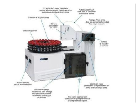
吹扫捕集法吹扫捕集法从理论上讲,是动态顶空技术,是用流动气体将样品中的挥发性成分"吹扫"出来,再用一个捕集器将吹扫出来的有机物吸附,随后经热解吸将样品送入气相色谱仪进行分析。通常,称动态顶空技术为吹扫捕集进样技术。待吹扫的样品可以是固体,也可以是液体样品,吹扫气多采用高纯氦气。捕集器内装
