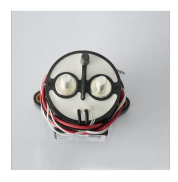
选用高压直流继电器时,要有相对的电路条件。电流继电器要求恒流源电路条件,即回路有较大阻抗与之串联,它本身阻抗对回路电流影响很小。电压继电器要求提供恒定的电压。电流继电器当作电压继电器用,因其线圈电阻小,很容易烧坏线圈,甚至造成电源短路。如将电压继电器当电流继电器使用线圈串接在线路里时,由于其大的阻抗会明显地改变原来回路参数,会因线圈得不到足够的电流而继电器不动作。值得注意的是交流继电器线圈通常承受过电压的能力比直流继电器差。在直流继电器线圈中,外加电压的增加所引起电流增加的速率较低。这是因为线圈的温升引起线圈电阻的上升。然而在交流继电器中,外加电压的增加引起电流的增加,同样引起线圈电阻增加,这将造成导磁零件进一步饱和,使感抗进而使阻抗大幅度下降。结果是线圈电流增加速率要比外加电压增加的速率快,因此,由于外加过电压造成的过热比直流继电器容易发生。高压直流继电器通常都有能反映一定输入变量。河北直流供电回路接触器哪家好
